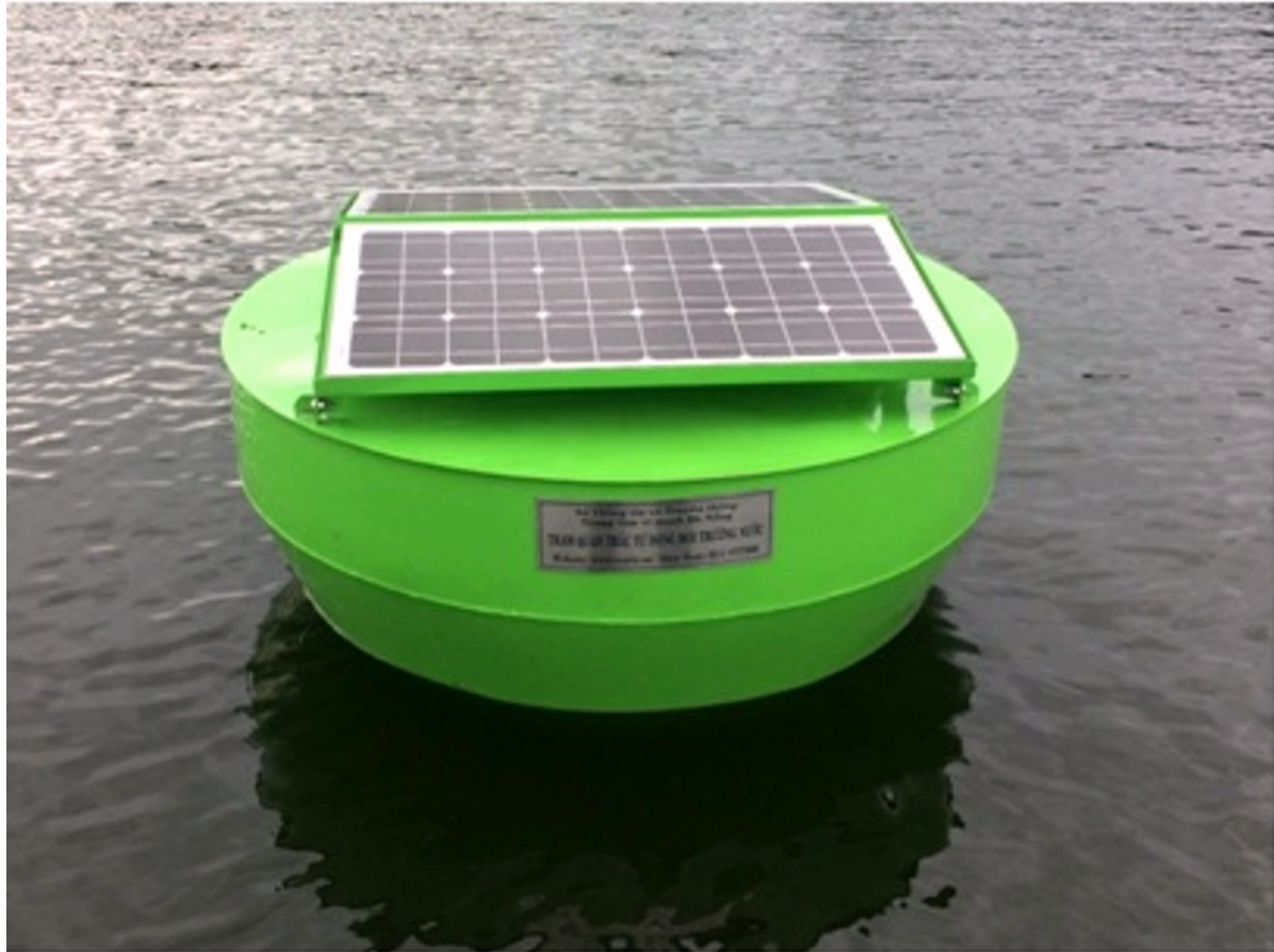
Hệ thống quan trắc nước được lắp đặt nhằm cảnh báo ô nhiễm môi trường
